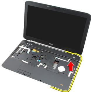
16. Lösen Sie die Halterungen an der linken Seite der Handballenstützen-Baugruppe und entfernen Sie die Handballenstütze.
