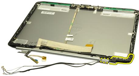
15. Ziehen Sie das durch den rechten Scharnierschacht geführte Antennenkabel durch die Öffnung auf der rechten Seite.
