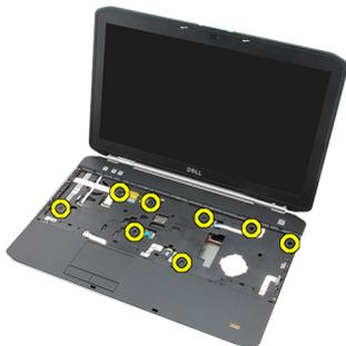
10. Trennen Sie das Kabel der Mediensteuerungstasten.
