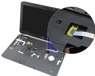
14. Trennen Sie das Fingerprint-Kabel.
