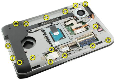
9. Drehen Sie den Computer um und entfernen Sie die Schrauben an der Handballenstütze.
