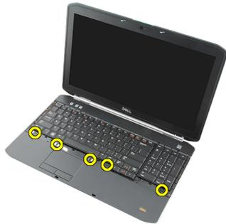
6. Heben Sie die Tastatur an den Kanten und drehen Sie sie um.
