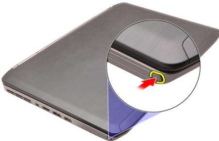
3. Drücken Sie auf die PC-Entriegelung, um die PC Card zu entriegeln.
