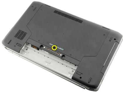
5. Drehen Sie den Computer um und entfernen Sie die Schrauben, mit denen die Tastatur an der Vorderseite des Computers befestigt ist.
