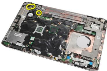
18. Schieben Sie den linken Haltebügel entlang des Modemkabels und entfernen Sie ihn vom Computer.
