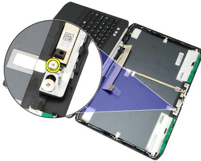
7. Heben Sie das Kameramodul an, und entfernen Sie es.
