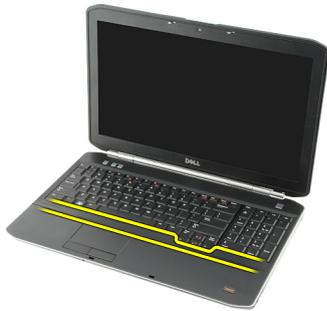
4. Hebeln Sie das Tastaturgehäuse an der Oberkante nach oben.
