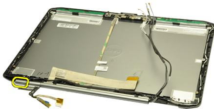
18. Entfernen Sie die linke Bildschirmscharnierkappenschacht.
