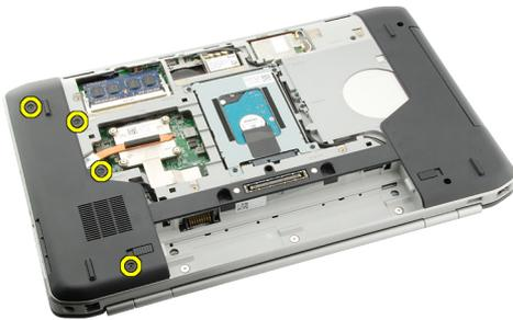
5. Entfernen Sie die CPU-Klappe.
