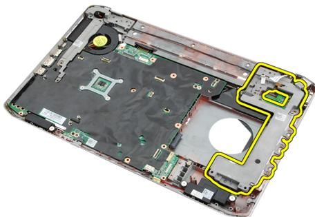
15. Trennen Sie das Modemkabel vom Modem.
