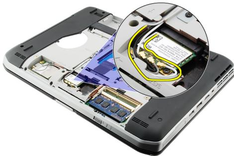
5. Entfernen Sie die Schraube, mit der die WLAN-Karte an der Systemplatine befestigt ist
