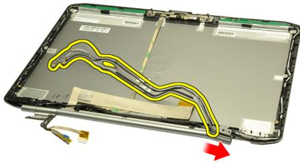
16. Ziehen Sie den rechten Scharnierschacht entlang der Antennenkabel und entfernen Sie ihn.
