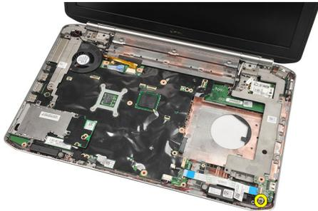
12. Entfernen Sie die Audioplatine.
