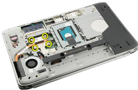
6. Heben Sie den Kühlkörper an und entfernen Sie ihn aus dem Computer.
