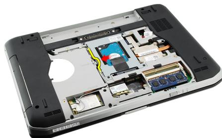
6. Entfernen Sie das optische Laufwerk aus dem Computer.
