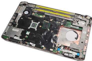
17. Entfernen Sie die Schrauben, mit denen der linke Haltebügel befestigt ist.
